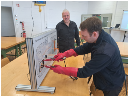
Ein Schulungsteilnehmer beim Messen der Spannungsfreiheit nach Trennung der Hochvoltbatterie anhand eines Modells
